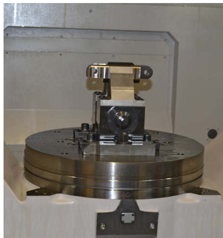
2. Kein Problem für die MU-500VA-L dank der direkten Wegmesssysteme: ein Werkstück, das auf maximal \pm 5 \mu\text{m} toleriert ist
