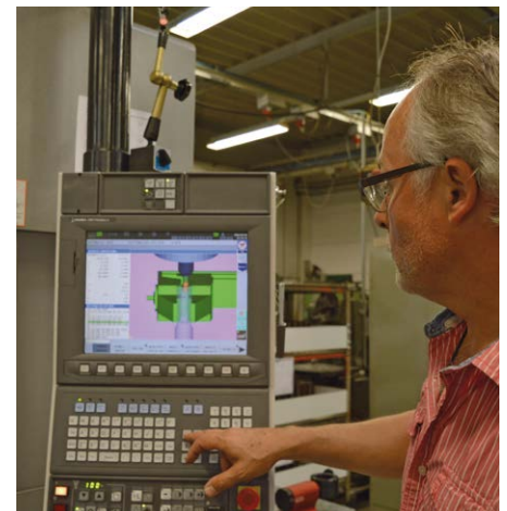
2. Kein Problem für die MU-500VA-L dank der direkten Wegmesssysteme: ein Werkstück, das auf maximal \pm 5 \mu\text{m} toleriert ist
