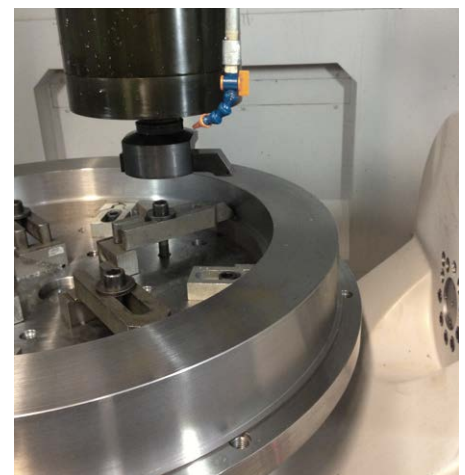
4. Aktuell sind circa 10 Prozent aller Bearbeitungen auf der MU-500VA-L 5-Achs-Simultanarbeiten und 90 Prozent 5-Seiten-Bearbeitungen; stets wird die kombinierte Drehfunktion genutzt
